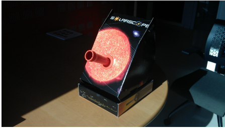
Figuur 14: De SolarScope maakt ook gebruik van een lens en een spiegel om op de binnenkant van de doos een zonsbeeld te projecteren.
