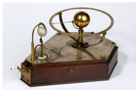
Figuur 3: Het mechanische model van Benjamin Cole. Door aan de hendel te draaien kan men 'Venus' om de 'zon' laten draaien
