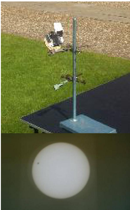
Figuur 13: Een variant op de Camera Obscura. In plaats van een grote doos met een klein gaatje in de zijkant wordt hier een klein spiegeltje op een standaard (links) gebruikt om de zon op een projectiescherm (rechts) te spiegelen. Deze opname is gemaakt tijdens de transit van Venus in 2004.
